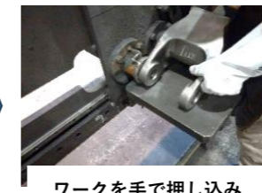
ワークを手で押し込み受け座へセットする
