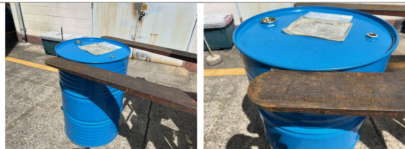
ドラム缶のフタの突起部にフォークの爪を引っ掛けているだけなので、振動等でドラム缶がフォークの爪から離脱する恐れがある。
