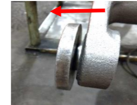
ワークを治具にはめ込む（矢印方向へ）
