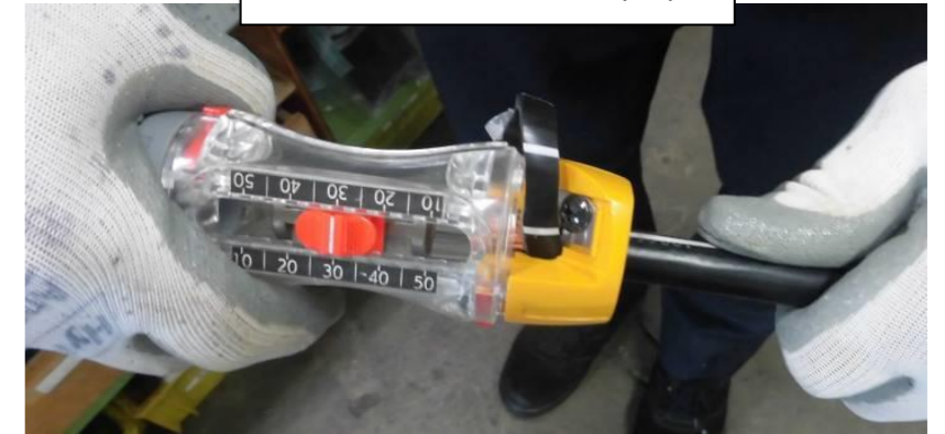
専用工具での被覆剥き作業
